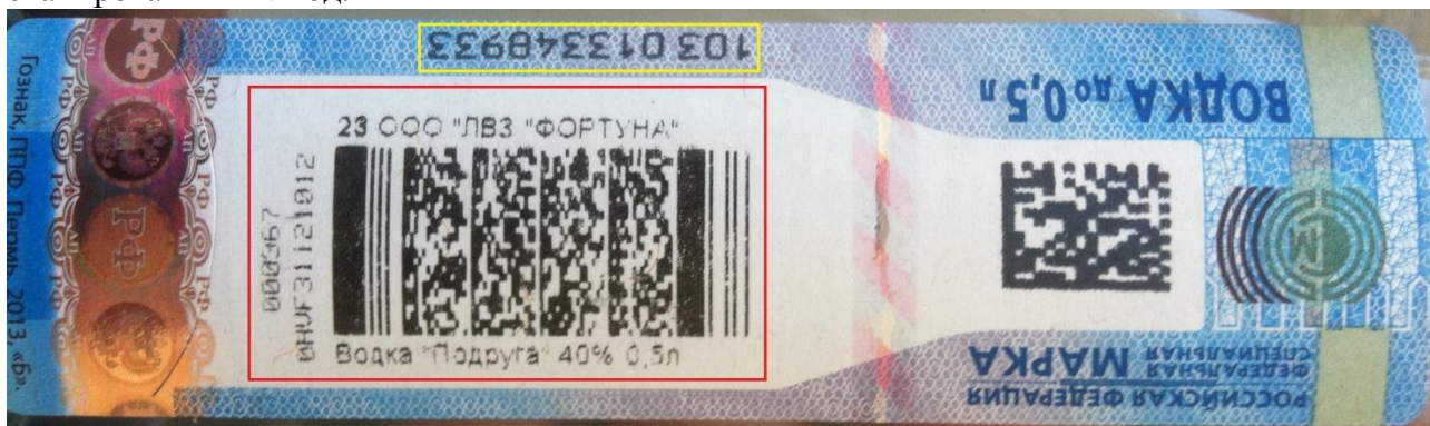
Рисунок 1. Изображен номер марки, формируемый ФГУП «Гознак» при ее производстве, обведен желтой рамкой. Двумерный штрих код PDF-417 обведен красной рамкой.
